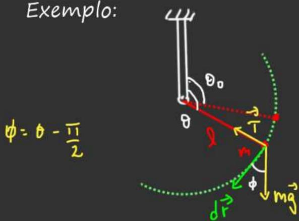
Partícula de massa  $m$  presa a uma haste rígida, inextensível, de massa desprezível e comprimento  $l$ . Liberada de um ângulo inicial  $\theta_0$  e com velocidade inicial  $v_0$ .
